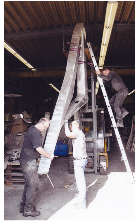
Die ausgekühlte Figur hängt am Gabelstapler und wird vom Chef der Gießerei (links) und seinen Mitarbeitern hinsichtlich ihrer Qualität begutachtet.
